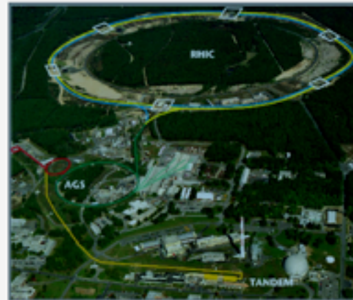
図 2: Brookhaven 研究所の RHIC 加速器。重イオンを右回りと左回りの 2 つのリング上で核子あたり 100GeV まで加速し、4ヶ所で衝突させて生成される粒子などを観測する。偏極した陽子を加速して陽子中のグルーオンなどの持つスピンを測る実験も行われている。
